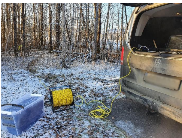
Figur 6. Kabel från ROV till kontrollenhet.
