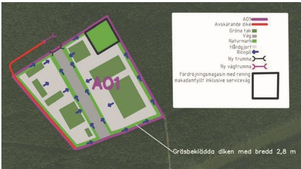
Figur 10. Skiss med föreslagen dagvattenlösning.
